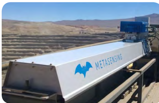
شکل ۴- رادار FastGB SAR شرکت Metasensing با قابلیت برداشت متوالی داده با سرعت کمتر از ۱۰ ثانیه.
